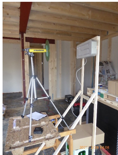
2. Messaufbau für elektrische Felder mit TCO-Sonde. Stromversorgung des Heizmoduls kam über Verlängerungsleitung am Boden seitlich vom Heizmodul.
